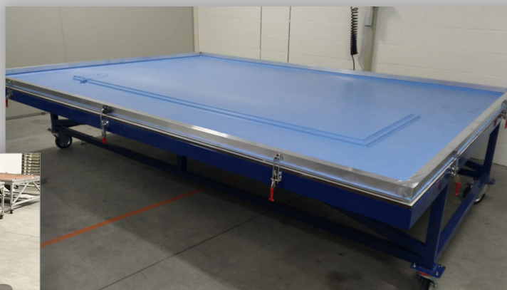
PRESSA A MEMBRANA PER SOTTOVUOTO Dimensione: 3500x3500mm
