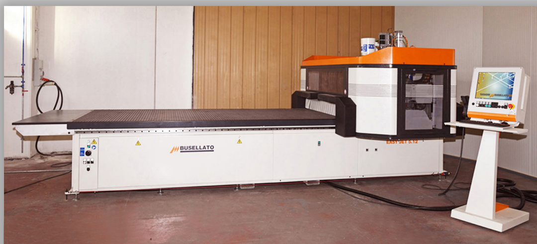
CENTRO DI LAVORO Modello BUSELLATO EASY JET 7X14 campo di lavoro: 2200x4750
