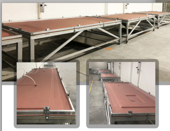
PRESSA A MEMBRANA PER SOTTOVUOTO Dimensione: 3500x3500mm
